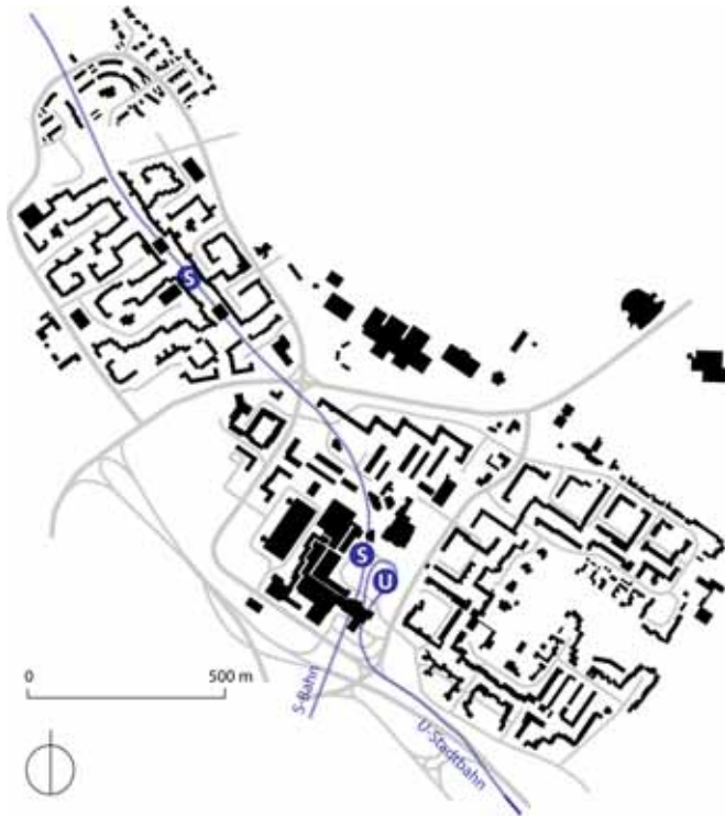
Abbildung 18: Musterbeispiel für den Städtebau nach dem Leitbild „Urbanität durch Dichte“: Köln-Chorweiler (1960 – ca. 1990), konzipiert als Bandstadt mit hoher Dichte und daher ideal für die Anbindung durch Schnellbahnen (eigene Darstellung nach Reinborn 1996).
